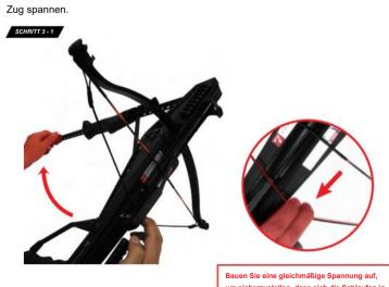
Wenn Sie die Spannschnur richtig spannen, bewegt sich die Sicherung automatisch in die SAFE-Position (grüner Punkt).
